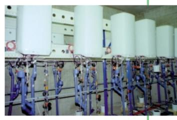
Der Prüfstand: In einer ganzen Batterie derartiger Warmwasserspeicher prüften wir, ob die Wasserbehandler Kalkablagerungen vermindern können oder ob nicht – immer unter gleichen Versuchsbedingungen.
